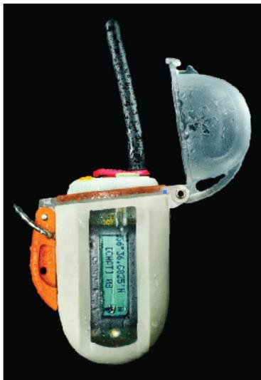
**Nautilus Lifeline** – это современная, высокотехнологичная и компактная УКВ радиостанция с интегрированным GPS приемником,
